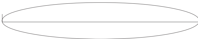
1a. Vibração de uma corda em toda a sua extensão (Som A).
