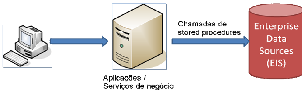
Figura 30 – Aplicações acessam diretamente as fontes de dados através de stored procedures
