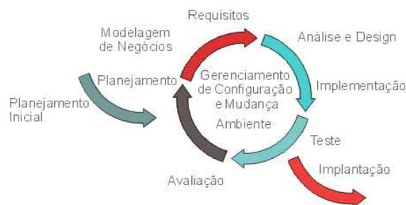
**Figura 2:** Disciplinas em uma iteração do RUP
