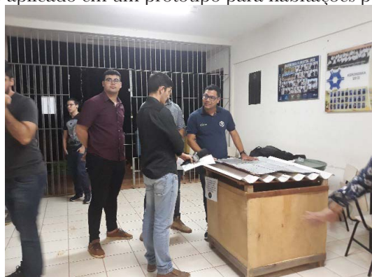
Imagem 2 – Projeto: reuso de embalagens descartáveis como alternativa para isolamento térmico: experimento aplicado em um protótipo para habitações populares
