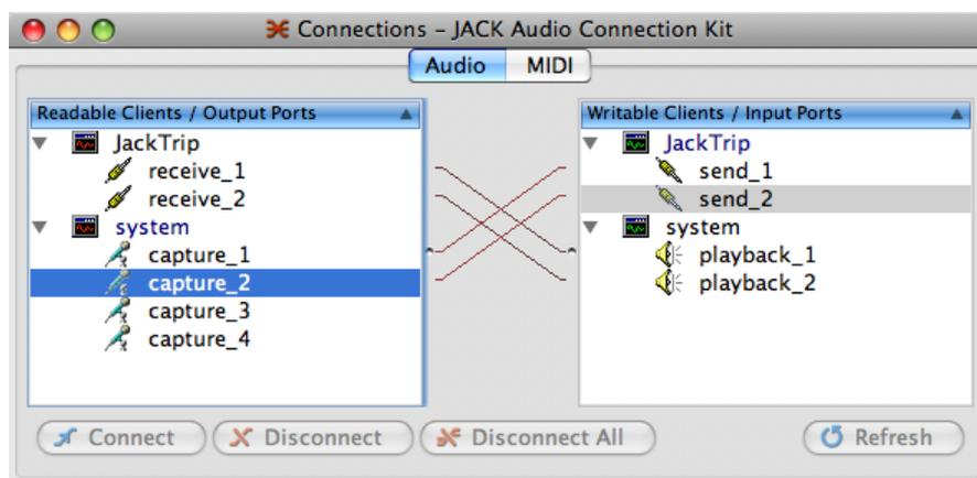
**Figura 1: Roteamento de sinal de áudio via Jacktrip.**
